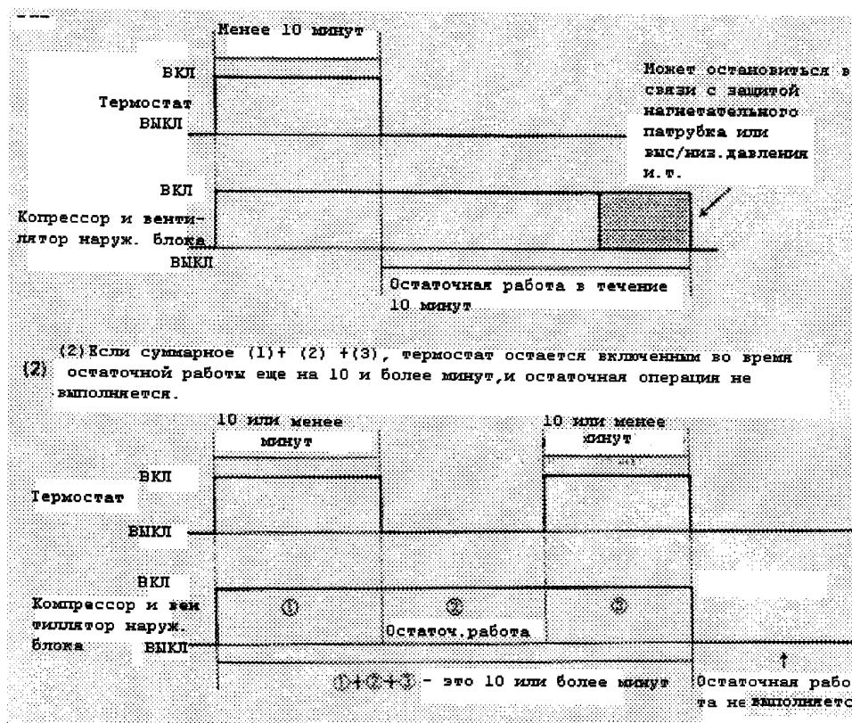
(3) Если при Th1 (температура наружного воздуха) – 5 °C и Th3-1 ниже 95 °C с OFF термостата или с дистанционного пульта и т. д. подана команда на прекращение работы, в течение 10 минут будет проводится остаточная работа без отказа. (Однако, может быть прекращена в связи с защитой нагнетательного патрубка или высоким/низким давлением и т. д.)
